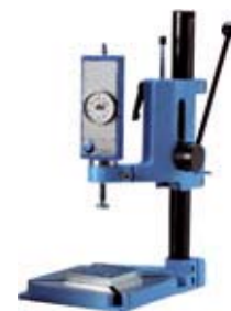
Bancos de pruebas 101 con medidor de fuerzas de tracción y compresión 1191
